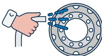
Lavar las ruedas con un inyector de alta presión o una manguera de agua para eliminar la suciedad persistente.
