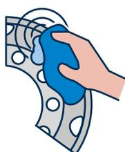
Pulir ejerciendo una firme presión con un paño fino de algodón o un cabezal de pulido para pulir la llanta.
