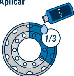
Aplicar una pequeña cantidad de **Wheel polish SLT 120** sobre una sección de la llanta (1/3 de la llanta, como máximo).
